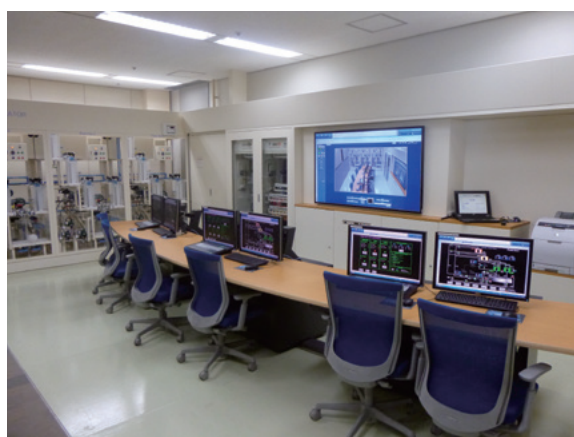
No.5 新訓練シミュレータ：横河電機社製（2013年10月更新）
